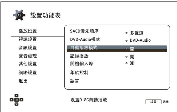
3. 按上/下方向鍵選擇要修改的功能表項，然後按 **ENTER** 或**右**方向鍵打開選擇項。當**設置功能表**頂部或底部出現滾動圖示時，則表示還有更多項未顯示，可通過**上/下**方向鍵移動選擇。
