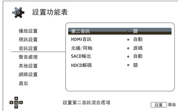
1. **第二音訊**：設置第二音訊。有些藍光光碟經常包含第二音/視訊，如導演評注等。有些藍光光碟可以在您進行功能表選擇時發出特定聲音。通過此功能表項，您可決定是否將第二音訊和功能表音效混合進主音訊中。
